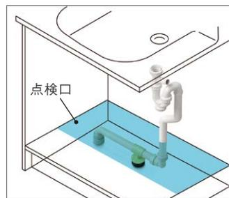
点検口は、既設の排水口への接続がしやすい大きさ。接続部分を目視確認できて安心です。
